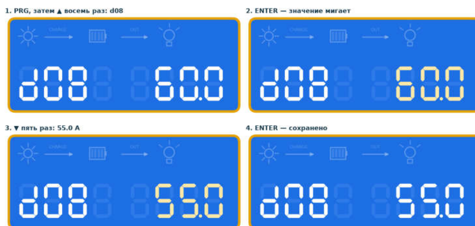
Рис. 8. Пример: ограничение тока заряда 55 А.
