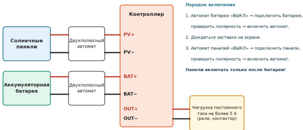
Рис. 1. Схема подключения: панели и батарея подключаются через отдельные двухполюсные автоматы.
