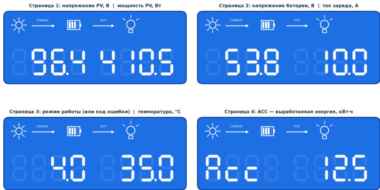
Рис. 5. Четыре страницы экрана. Значки вверху показывают состояние: панели, заряд, батарея, нагрузка на выходе OUT.
