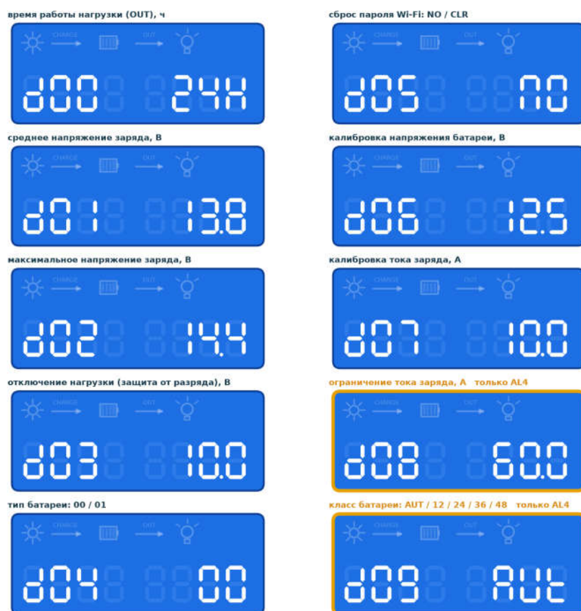
Рис. 7. Все пункты меню (значения для батареи 12 В). Пункты d08 и d09 есть только в AL4 — они выделены рамкой.
