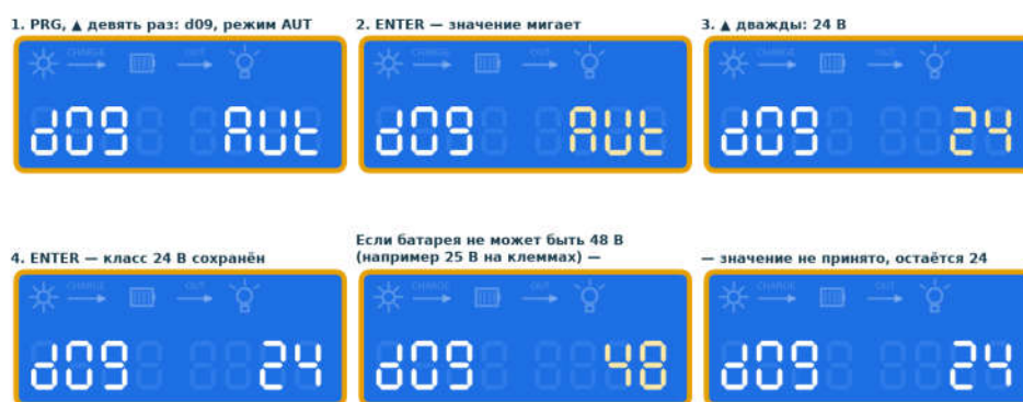
Рис. 10. Пример: выбор класса 24 В. Если подключённая батарея не может быть выбранного класса, значение не принимается.
