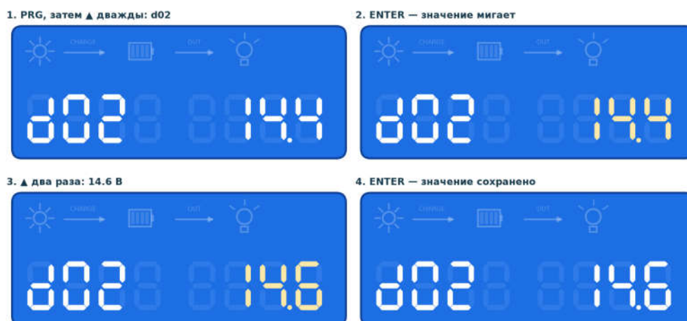
Рис. 6. Пример: изменение максимального напряжения заряда (d02) с 14,4 В до 14,6 В.
